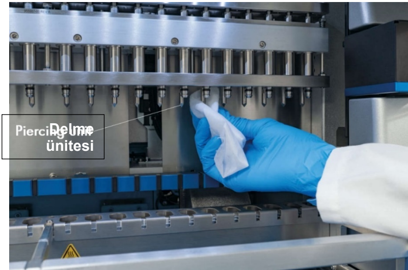
Şekil 147. EZ2 delme ünitesini temizleme.
