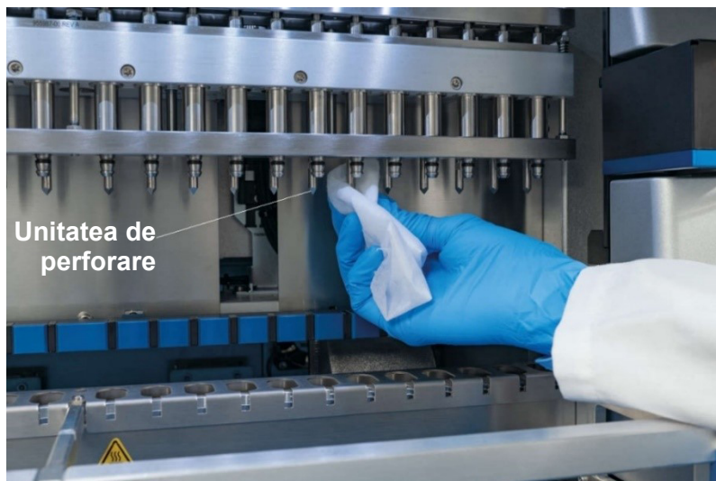
Figura 147. Curățarea unității de perforare EZ2.
