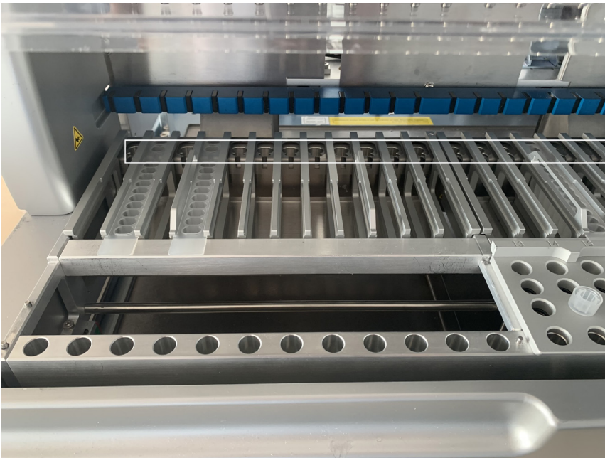
Figura 16. Pozițiile care pot fi încălzite din stativul pentru cartușe (marcate cu chenar alb).
