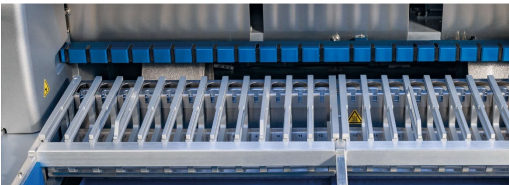
Abbildung 12. Herausnehmbares Kartuschenrack im Gerät.
