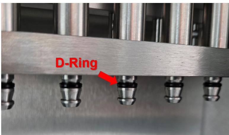
Abbildung 177. Pipettenspitzenadapter mit hervorgehobenem D-Ring.
