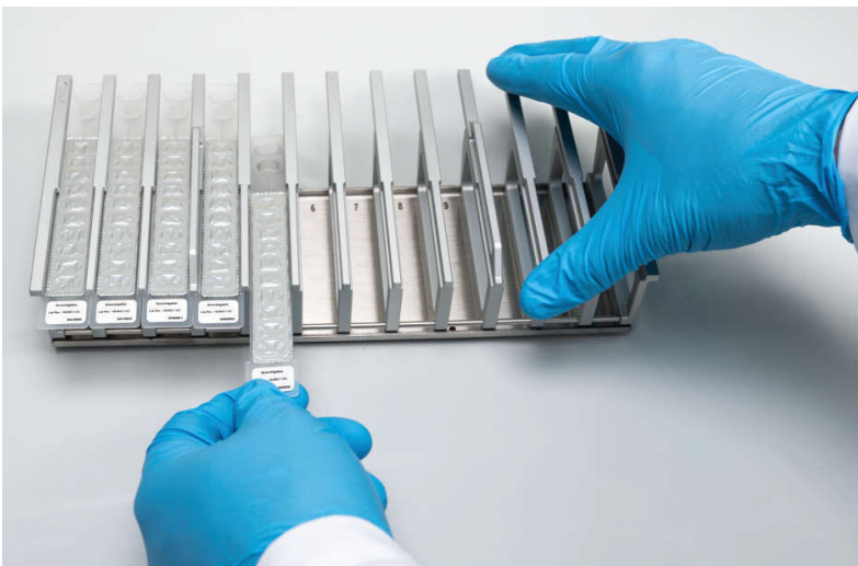
Abbildung 11. Kartuschenrack mit eingesetzten Kartuschen.
