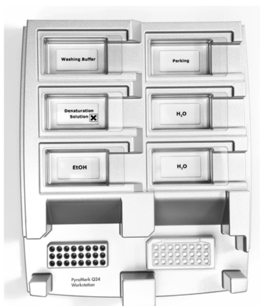
Afbeelding 2. Plaatsing van de PCR-plaat (of -strips) en PyroMark Q24 Plate op het vacuümwerkstation.
