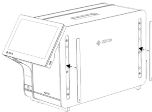
5. Collegare il ponte moduli analitico/operativo sul retro del DiagCORE Analyzer per collegare tra loro i moduli operativo e analitico.
