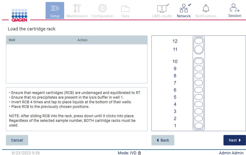
Afbeelding 141. Het cartridgerek inladen.
