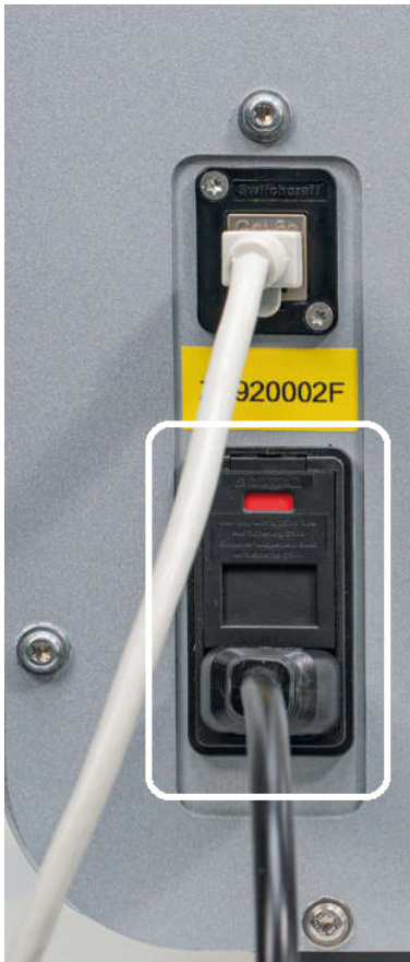
Figur 7. Plassering av strømkontakten (framhevet av en hvit ramme).
