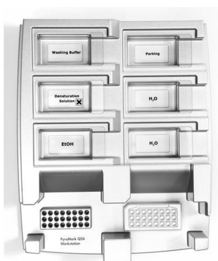
Figur 2. Plassering av PCR-plate (eller remser) og PyroMark Q24-plate på vakuumarbeidsstasjonen.
