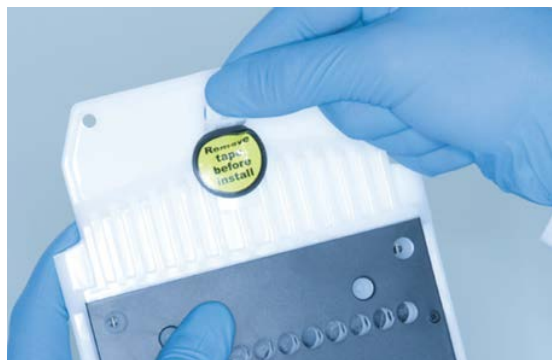
Joonis 6. Geelikasseti QIAxcel Gel Cartridge ettevalmistamine.
