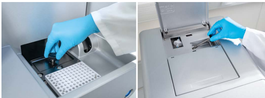
Joonis 3. Transpordiluku eemaldamine.
