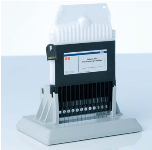
Abbildung 7. Inkubation auf dem QX Cartridge Stand.
