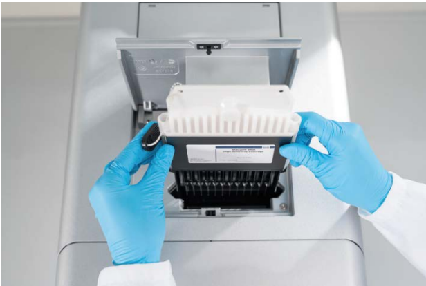
Abbildung 9. Installation der QIAxcel Gel Cartridge.
