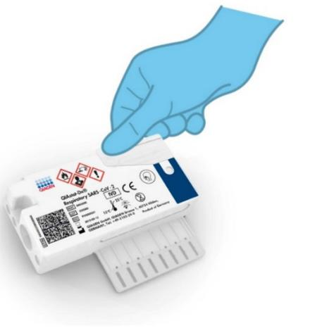
**Figura 42. Cierre de la tapa de la muestra del puerto principal.**
