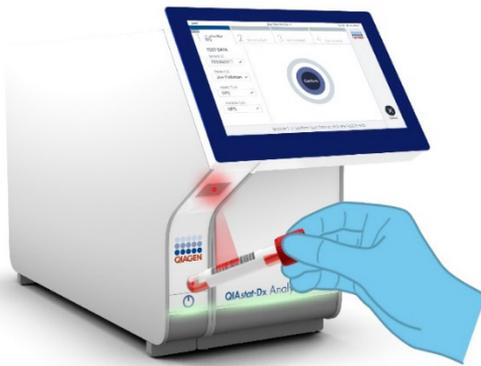
**Figura 44. Escaneo del código de barras del identificador de la muestra.**
