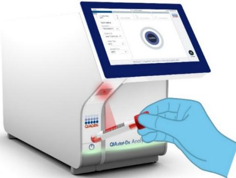
**Figura 11. Escaneo del código de barras del identificador de la muestra.**
