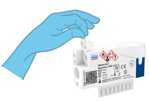
**Figura 7. Apertura de la tapa de la muestra del puerto para hisopo.**
