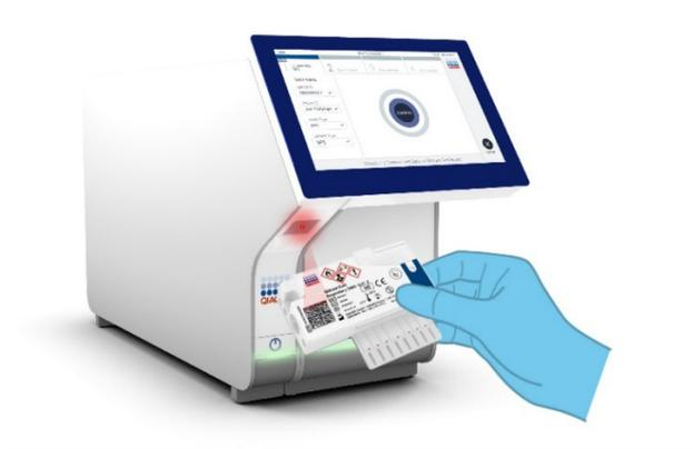
Figura 45. Escaneo del código de barras del QIAstat-Dx Respiratory SARS-CoV-2 Panel Cartridge.
