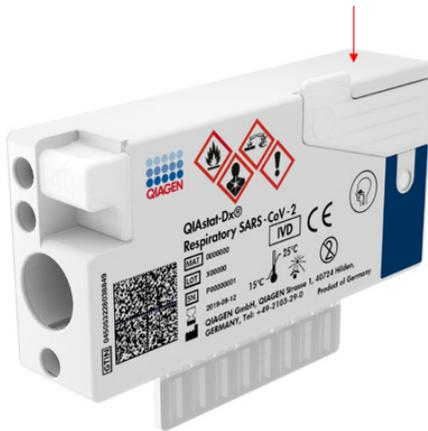
**Figura 51. Colocación del código de barras del identificador de muestra.**
