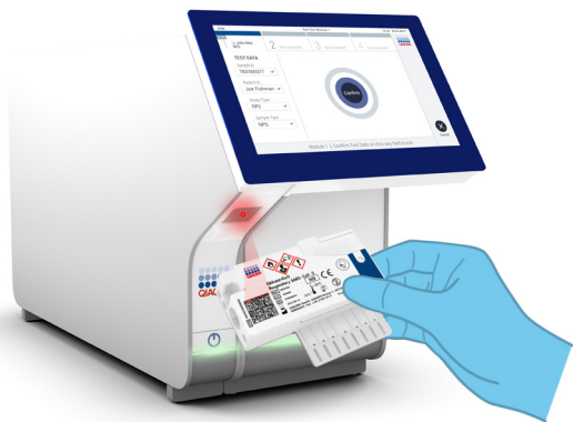
Ryc. 25. Skanowanie kodu kreskowego kasety QIAstat-Dx Respiratory SARS-CoV-2 Panel Cartridge.
