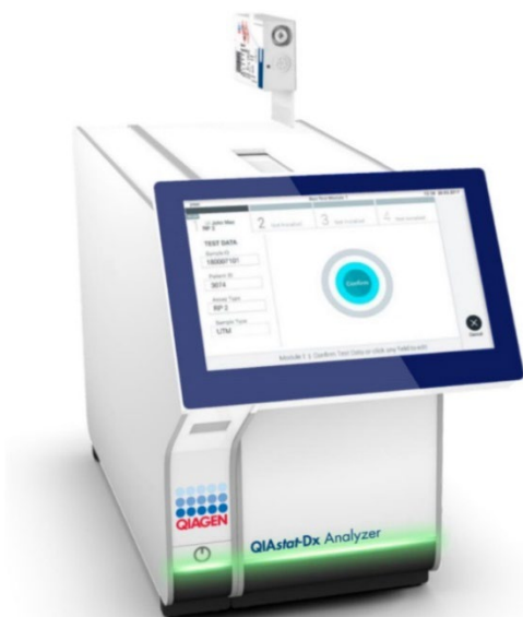
Obrázek 48. Vkládání kazety QIAstat-Dx Respiratory SARS-CoV-2 Panel Cartridge do přístroje QIAstat-Dx Analyzer 1.0 nebo QIAstat-Dx Analyzer 2.0.
