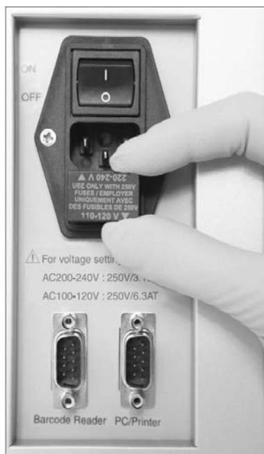
选择正确的保险丝 100-120 V 线路电源。
