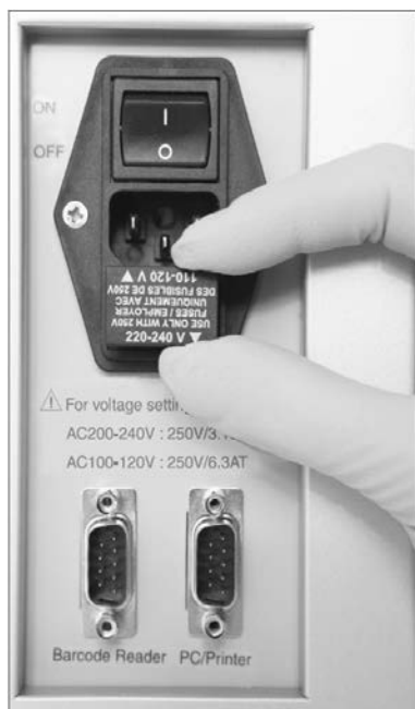
选择正确的保险丝 200-240 V 线路电源。
