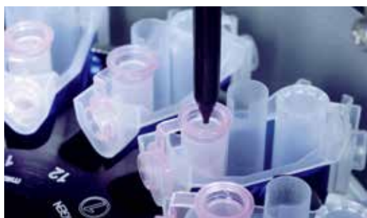
図 4. QIAcube に直接使用できるセット済みのローターアダプター
