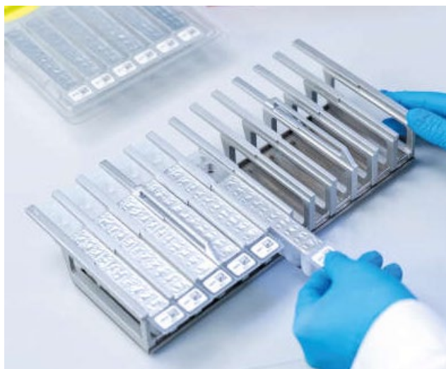
3. attēls. Reaģentu kasetņu statīvs. Uz kasetņu statīva ir atzīmēta bultiņa, kas norāda reaģentu kasetņu (RCB) ievietošanas virzienu.
