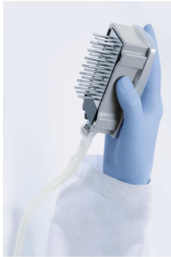
Afbeelding 4. Afbeelding van het vacuümhulpmiddel dat omhoog is gebracht voorbij een verticale hoek van 90°.
