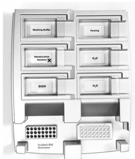
Imagem 2. Colocação da placa de PCR (ou tiras) e da placa PyroMark Q24 na estação de trabalho de vácuo.
