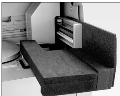
Proteção de espuma introduzida entre a centrífuga e o braço robótico.
