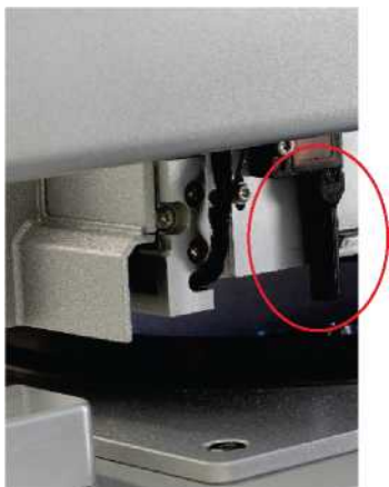
Ультрадыбыстық датчиктің қара сәуле коллиматоры (қызыл шеңбер).
