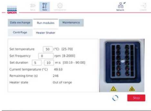
Шейкер қыздырғышының жұмыс экраны.
