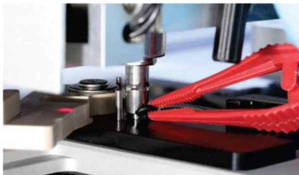
Сұр рычагты ашыңыз және пинцеттің көмегімен тығыздағыш сақинаны алыңыз.
