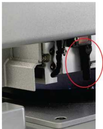
Ультрадыбыстық датчиктің қара сәуле коллиматоры (қызыл шеңбер).
