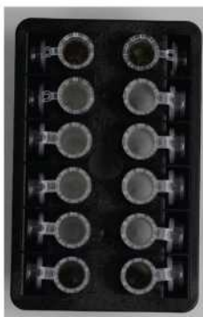
Үлгілері бар пробиркалардың қақпақшалары шейкер штативінің шетіндегі кертіктерге сенімді енгізілуі тиіс.
