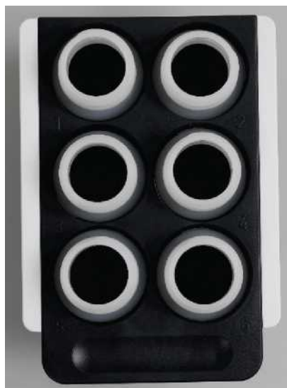
Бүйірінде ақ таңбалау жолақтарымен реагенттері бар пробиркаларға арналған штатив.
