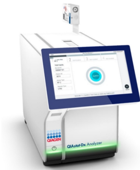
Figura 48. Inserimento della QIAstat-Dx Respiratory SARS-CoV-2 Panel Cartridge nel QIAstat-Dx Analyzer 1.0 o nel QIAstat-Dx Analyzer 2.0.
