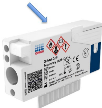
Obrázek 38. Umístění informací o alikvotu na horní straně kazety QIAstat-Dx Respiratory SARS-CoV-2 Panel Cartridge.
