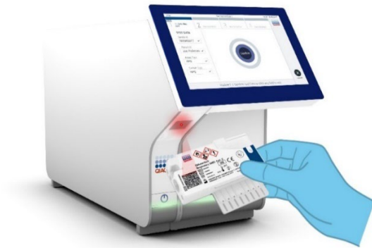
Фигура 12. Сканиране на баркод на QIAstat-Dx Respiratory SARS-CoV-2 Panel Cartridge.
