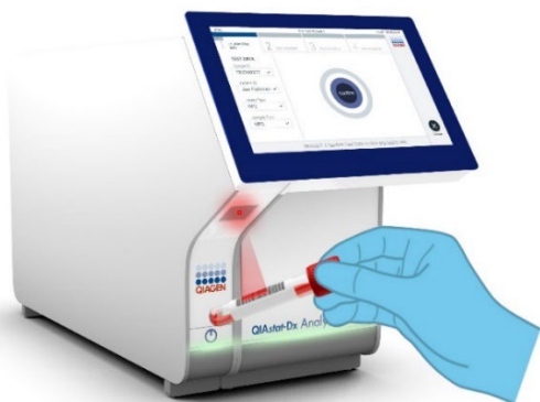
Фигура 11. Сканиране на баркод с идентификатора на аликвотната част.
