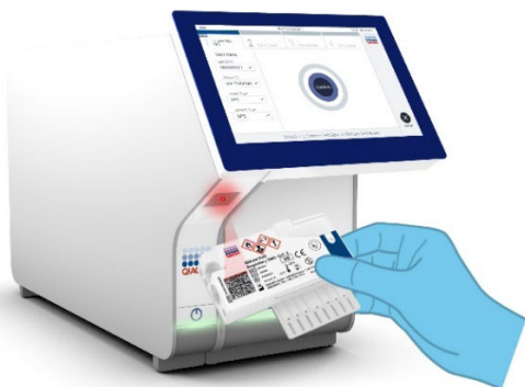
Фигура 45. Сканиране на баркод на QIAstat-Dx Respiratory SARS-CoV-2 Panel Cartridge.
