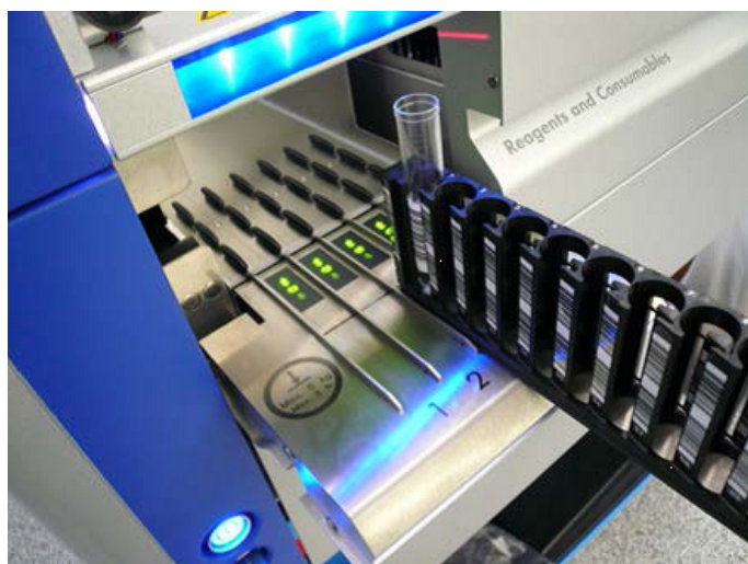
Deslizar um porta-tubos para a ranhura apropriada.
