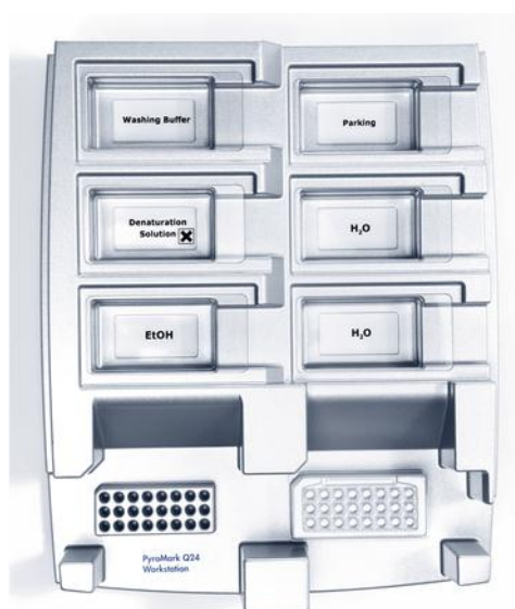
Obrázek 3. Uložení PCR destičky a destičky PyroMark Q24 do vakuové stanice.
