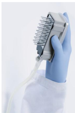
Obrázek 4. Zobrazení vakuové hlavice naklopené svisle přes 90°.
