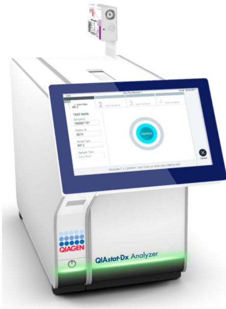
Figure 13. Insertion de la QIAstat-Dx Gastrointestinal Panel 2 Cartridge dans le QIAstat-Dx Analyzer 1.0 ou le QIAstat-Dx Analyzer 2.0.
