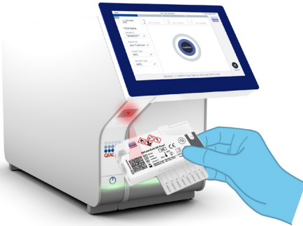
Şekil 12. QIAstat-Dx Meningitis/Encephalitis Panel Cartridge barkodunu tarama.
