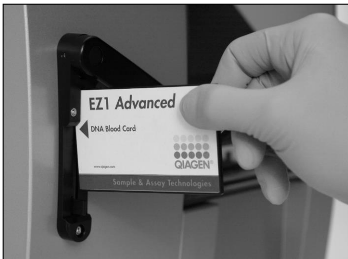
Figur 9. Nem protokolopsætning ved brug af EZ1-kort. Indsætning af et EZ1-kort, der indeholder protokollen, i EZ1-instrumentet.
