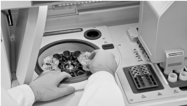
Figur 21: Placering af centrifugen på QIAcube Connect MDx. Placer de samlede rotoradaptere i centrifugespandene.
