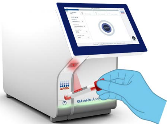
12-сурет. Үлгі идентификаторының штрих-кодын сканерлеу.
