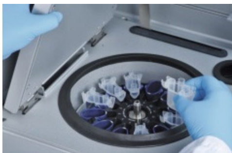
Rimozione degli adattatori per rotore.
