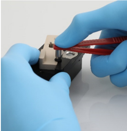
Spingere in basso il pernetto con la parte posteriore della pinza.
