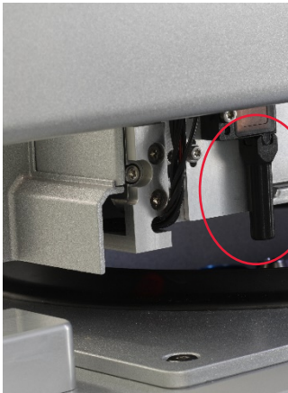
Collimatore a fascio nero (vedere cerchio rosso) del sensore a ultrasuoni.
