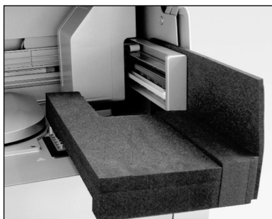
Protezione in espanso del braccio robotico.
