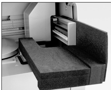
Protezione in espanso inserita tra centrifuga e braccio robotico.
