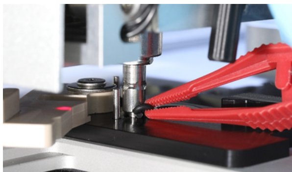
Aprire la levetta grigia e rimuovere l'O-ring con la pinza.
