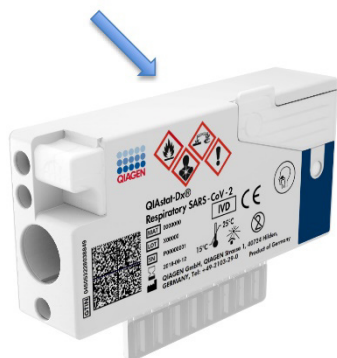
Figur 38. Placering af prøveinformation på toppen af QIAstat Dx Respiratory SARS CoV 2 Panel Cartridge.
