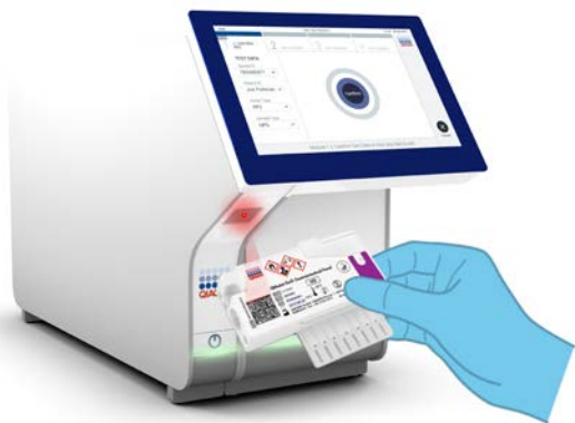
Slika 13. Skeniranje bar-kôda kertridža QIAstat-Dx Gastrointestinal Panel Cartridge.
