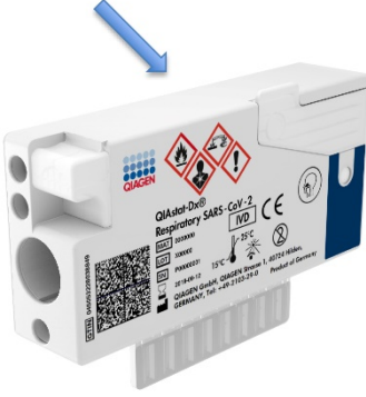
Şekil 38. QIAstat-Dx Respiratory SARS-CoV-2 Panel Cartridge'in üstüne örnek bilgilerini yerleştirme.
