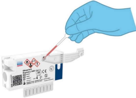
Şekil 41. QIAstat-Dx Respiratory SARS-CoV-2 Panel Cartridge'in ana portuna örnek aktarma.
