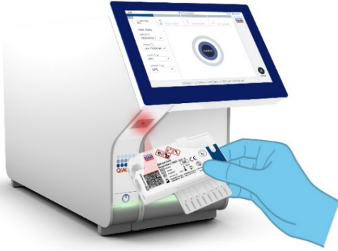
Şekil 45. QIAstat-Dx Respiratory SARS-CoV-2 Panel Cartridge barkodunu tarama.
