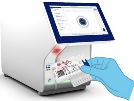
Şekil 12. QIAstat-Dx Respiratory SARS-CoV-2 Panel Cartridge barkodunu tarama.
