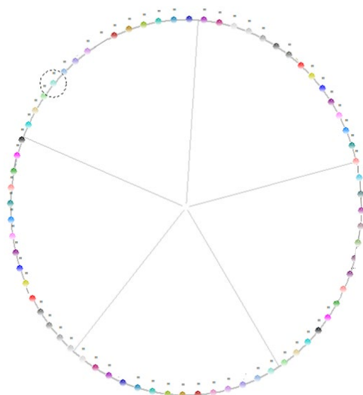
Figura 2. Exemplo da disposição dos tubos na plataforma RGQ MDx 5plex HRM
