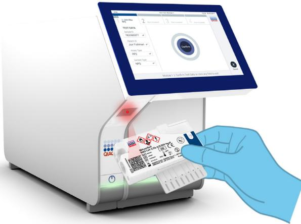
Abbildung 12. Scannen des Barcodes der QIAstat-Dx SARS-CoV-2/Flu A/B/RSV Panel Cartridge.
