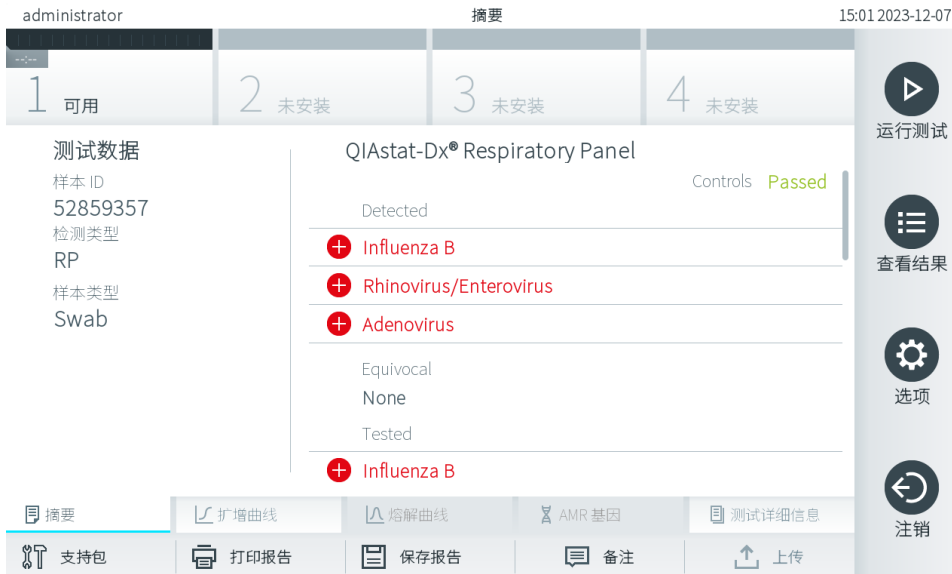
图 33. 结果 Summary（摘要）屏幕示例，其中在左侧面板中显示 Test Data（测试数据），在主面板中显示测试 Summary（摘要）。
