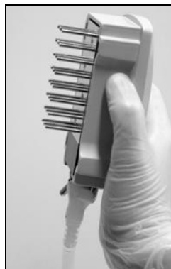
3 pav. Vakuuminio įrankio, pakelto daugiau nei 90° vertikaliai, iliustracija.
