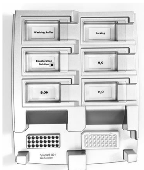
2 pav. PGR plokštelės (arba juostelių) ir „PyroMark Q24“ plokštelės dėjimas į vakuuminę darbo stotį.
