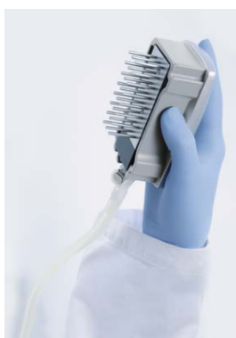
Rysunek 4. Narzędzie próżniowe uniesione celem odessania całego płynu z filtrów.
