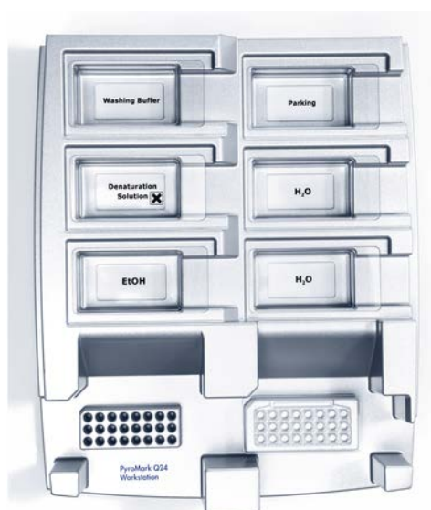
Rysunek 3. Umieszczanie płytki PCR oraz płytki PyroMark Q24 na stacji próżniowej.
