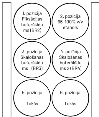
17. attēls. Reaģentu pudeļu statīva ievietošana. [A] Pudeļu pozīciju un saturs shēma reaģentu pudeļu statīvā. [B] Statīva ievietošana QIAcube Connect MDx instrumentā.
