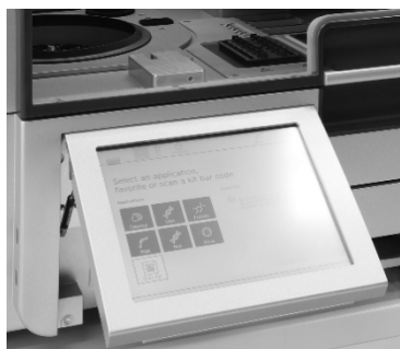
16. attēls. QIAcube Connect MDx skārienekrāns izvilkta stāvoklī.
