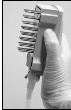
Figur 10. Visar vakuumverktyget när det höjts i vertikal riktning till en lutning på över 90°.
