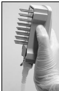
Figur 6. Visar vakuumverktyget när det höjts i vertikal riktning till en lutning på över 90°.
