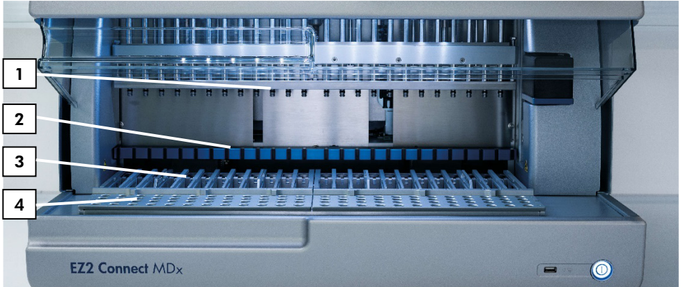
Figure 4. Vue d'ensemble d'un instrument EZ2 Connect MDx. (1) Tête de pipetage, (2) module aimanté, (3) support de cartouches et (4) portoir de pointes (support de laboratoire).
