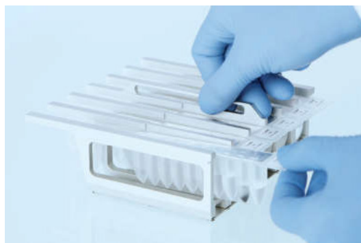
Figure 9. Chargement du portoir pour cartouche de réactif. La flèche figurant sur le support de cartouches indique dans quel sens les cartouches de réactif (RCV) doivent être chargées.
