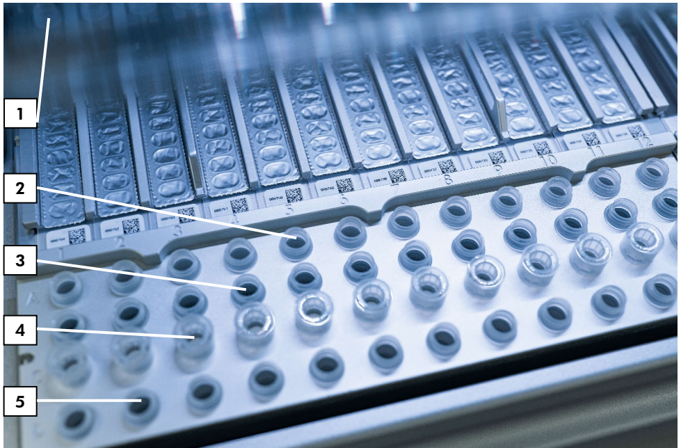
Figure 5. Plan de travail l'instrument EZ2 Connect MDx. (1) Bloc chauffant avec des tubes (ST) de 2 ml chargés dans les cartouches de réactif (RCV) pour la lyse. (2) Tubes d'échantillon (ST) (2 ml) chargés dans la rangée A. (3) Tube (ET) (1,5 ml) contenant l'ARN vecteur (CARRIER) et le contrôle interne (CI) (s'il est utilisé) dans le tampon d'élution (AVE), chargé dans la rangée B. (4) Supports de pointes jetables (DTH) contenant des pointes à filtres jetables (DFT) chargés dans la rangée C. (5) Tubes d'élution (ET) (1,5 ml) chargés dans la rangée D.
