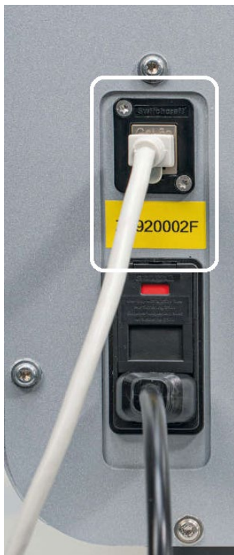
6. ábra Az RJ-45 port helye (fehér kerettel kiemelve).
