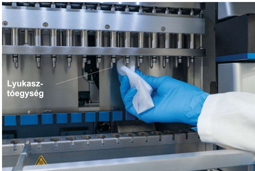
174. ábra Az EZ2 lyukasztőegységének tisztítása.
