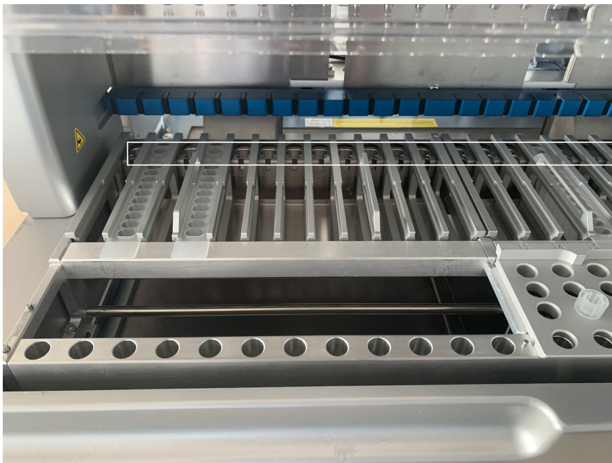
17. ábra Fűthető pozíciók a kazettatartó állványon (fehér kerettel kiemelve).
