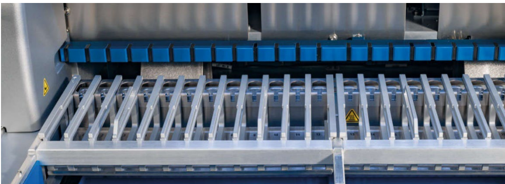
12. ábra Kivehető kazettatartó állvány a készülék belsejében.
