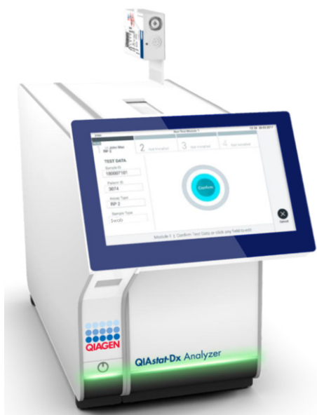
Joonis 15. Kasseti QIAstat-Dx Respiratory SARS-CoV-2 Panel Cartridge sisestamine analüsaatorisse QIAstat-Dx Analyzer 1.0 või analüsaatorisse QIAstat-Dx Analyzer 2.0.
