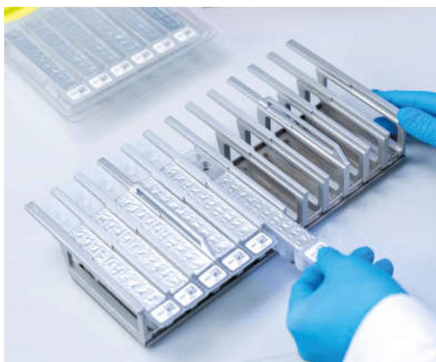
Slika 3. Stojalo za kartuše z reagenti. Stojalo za kartuše je označeno s puščico, ki označuje smer, kako je treba vstaviti kartuše z reagenti (RCV).
