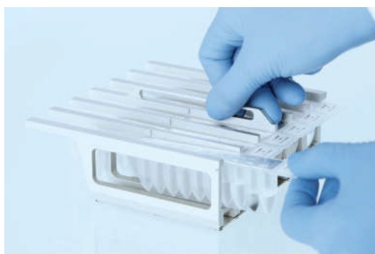
Slika 9. Vstavljanje kartuš z reagenti na stojalo. Stojalo za kartuše je označeno s puščico, ki označuje smer, kako je treba vstaviti kartuše z reagenti (RCV).
