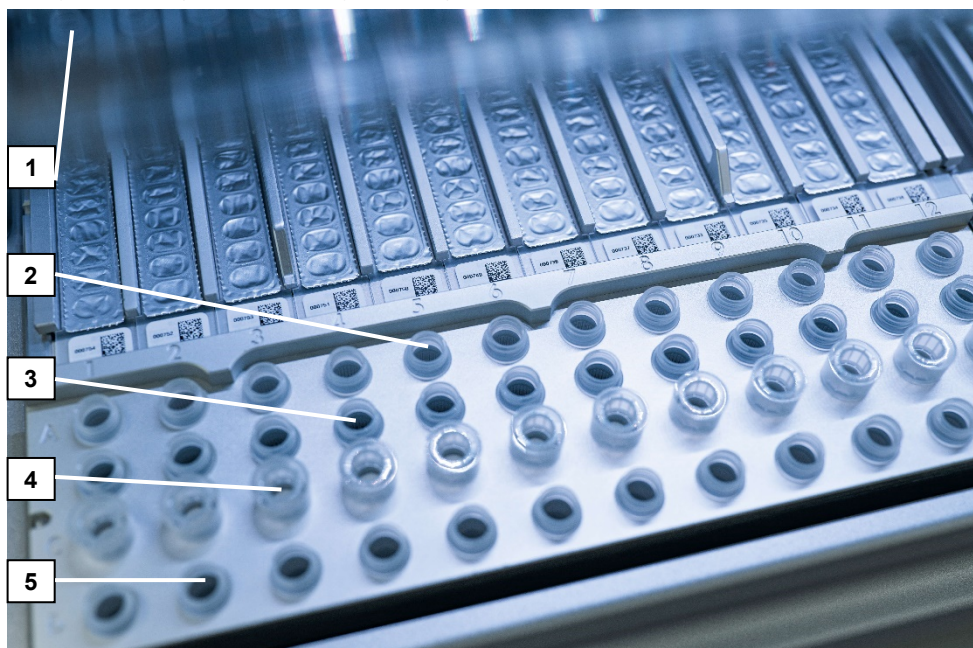
Slika 5. Delovna plošča instrumenta EZ2 Connect MDx. (1) Grelna enota z 2-ml epruvetami za vzorce (ST), vstavljenimi v kartuše z reagenti (RCV) za lizo. (2) Epruvete za vzorce (ST) (2 ml), vstavljene v vrstico A. (3) Epruvete za elucijo (ET) (1,5 ml) s prenašalno RNA (CARRIER) in interno kontrolo (Internal Control, IC) (če se uporablja) v elucijskem pufru (AVE), vstavljene v vrstico B. (4) Držala za konice za enkratno uporabo (DTH) s konicami za filtre za enkratno uporabo (DFT) vstavljeni v vrstico C. (5) Epruvete za elucijo (ET) (1,5 ml), vstavljene v vrstico D.
