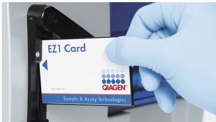
Slika 6. Enostavna nastavev protokola z uporabo kartic EZ1 DSP. Vstavljanje kartice EZ1 Card s predhodno programiranim protokolom v instrument EZ1.
