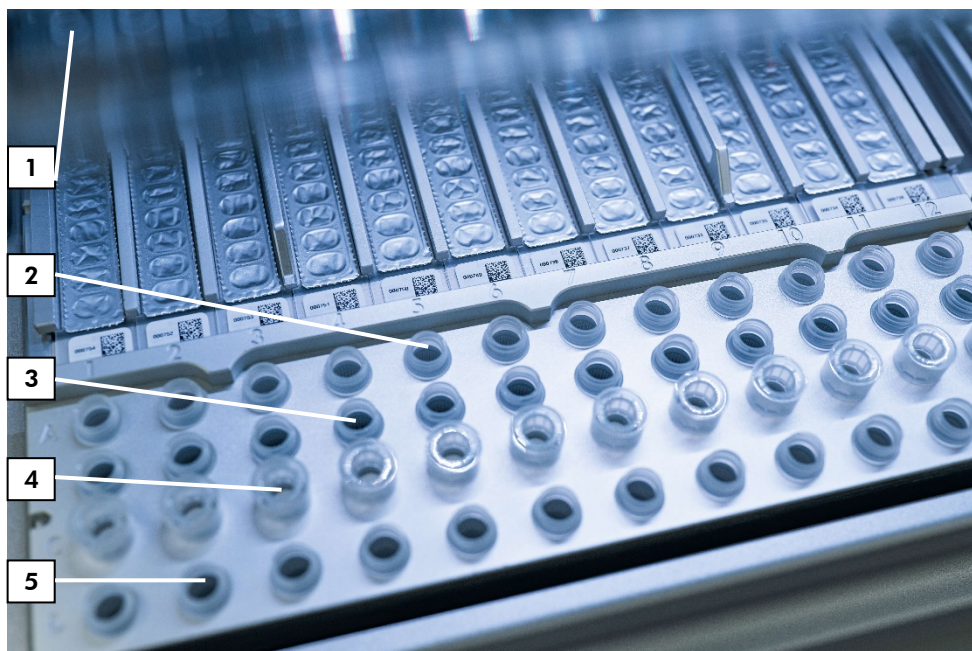
5. ábra. Az EZ2 Connect MDx készülék munkaasztala. (1) Fűtőblokk a reagenskazettába (RCV) töltött 2 ml csövekkel (ST) lizáláshoz. (2) Az A sorba betöltött mintacsövek (ST) (2 ml). (3) A B sorba betöltött cső (ET) (1,5 ml), amely hordozó RNS-t (CARRIER) és belső kontrollt (IC) (ha használták) tartalmaz eluáló pufferben (AVE). (4) A C sorba töltött egyszer használatos hegytartók (DTH), amelyek egyszer használatos, szűrővel rendelkező hegyeket (DFT) tartalmaznak. (5) A D sorba töltött eluációs csövek (ET) (1,5 ml).
