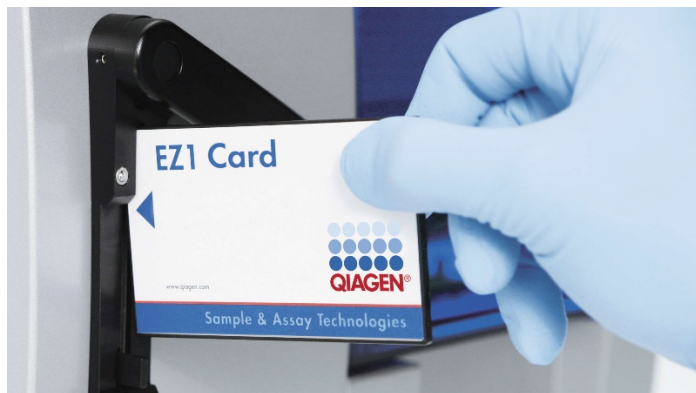
6. ábra. Az EZ1 DSP Card kártyák megkönnyítik a protokollok beállítását. A protokollal előre beprogramozott EZ1 Card behelyezése az EZ1 készülékbe.
