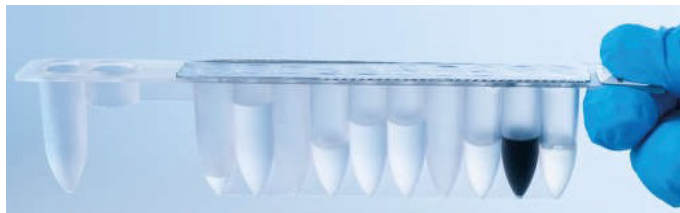
2. ábra. Reagenskazetta (RCV). Az EZ1 DSP Virus Kit lezárt, előre töltött reagenskazettája (RCV).
