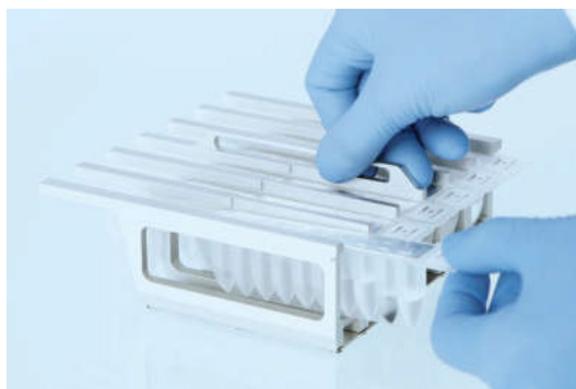
9. ábra. A reagenskazetta-tartó betöltése. A reagenskazetta-tartón látható nyíl jelzi, hogy milyen irányban kell betölteni a reagenskazettákat (RCV).
