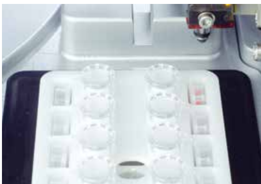
図 2. ヒートシェーカーにより最大 12 サンプルまでの溶解を自動化。
