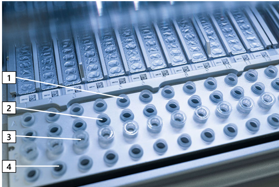
图 5 EZ2 Connect MDx 仪器的工作台。(1) 样品管 (ST) (2 ml) 装入 A 行。(2) 空的或可选的：装有 80% 乙醇的试管 (2 ml) 用于可选洗涤步骤，装入 B 行。(3) 一次性吸头架 (DTH) 和一次性过滤吸头 (DFT)，装入 C 行。(4) 洗脱管 (ET) (1.5 ml) 装入 D 行。
