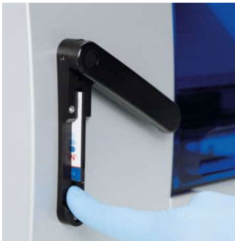
图 6：使用 EZ1 DSP 卡轻松设置规程。把 EZ1 卡（用规程进行了预编程）插入 EZ1 仪器中。
