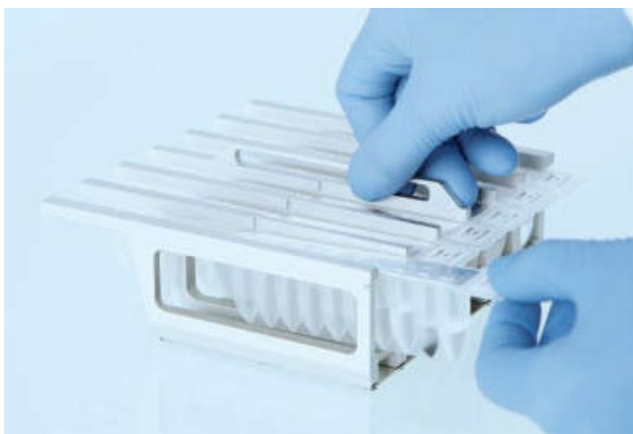
图 9 试剂盒架。试剂盒架本身标有箭头，以指示必须装载试剂卡夹（RCB）的方向。
