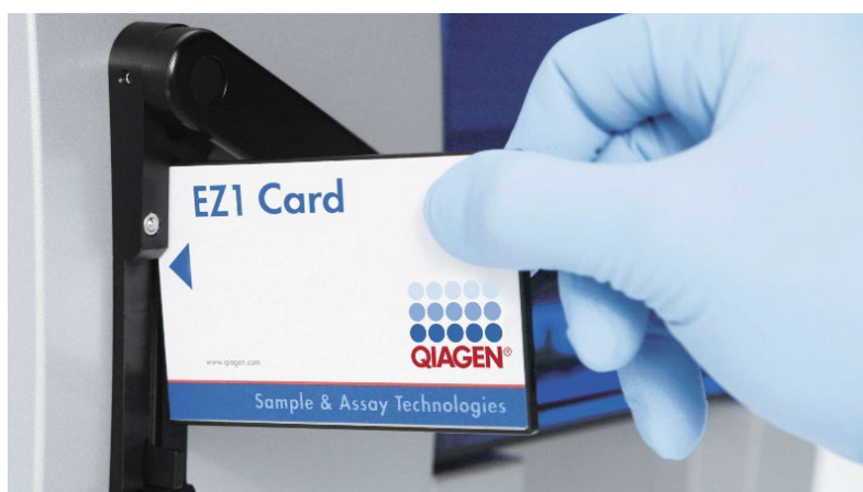
图 6：使用 EZ1 DSP 卡轻松设置规程。把 EZ1 卡（用规程进行了预编程）插入 EZ1 仪器中。
