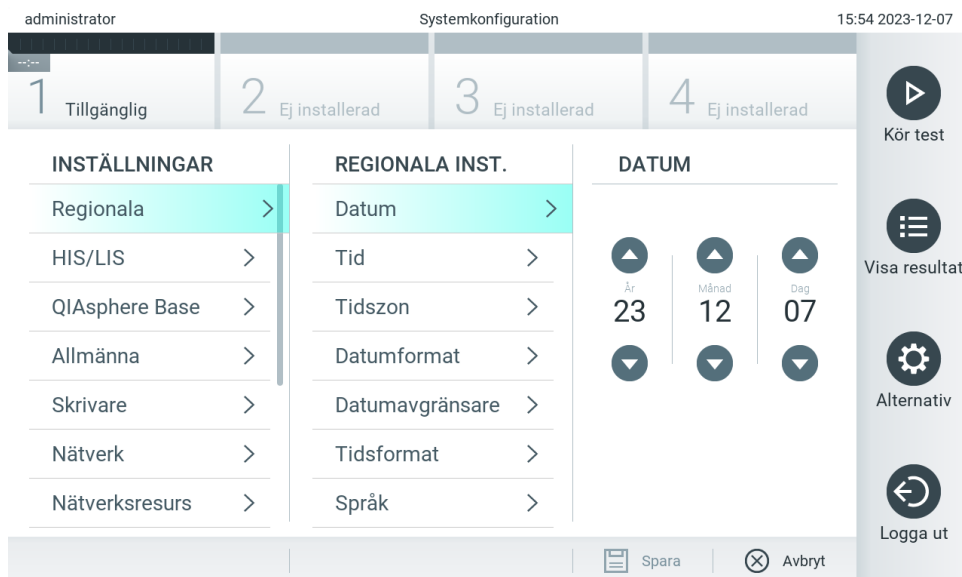
Bild 60. Ställ in systemets datum.
