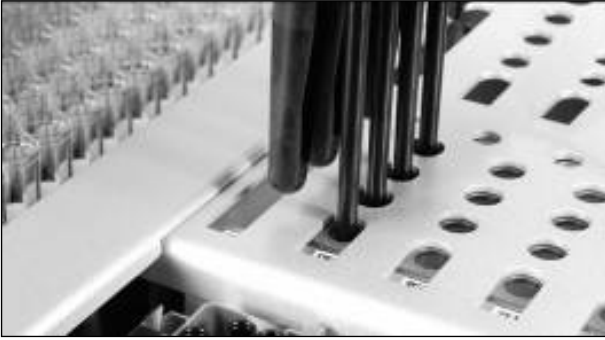
Uç koruyucuları çapraz kontaminasyonun önlenmesine yardım eder.
